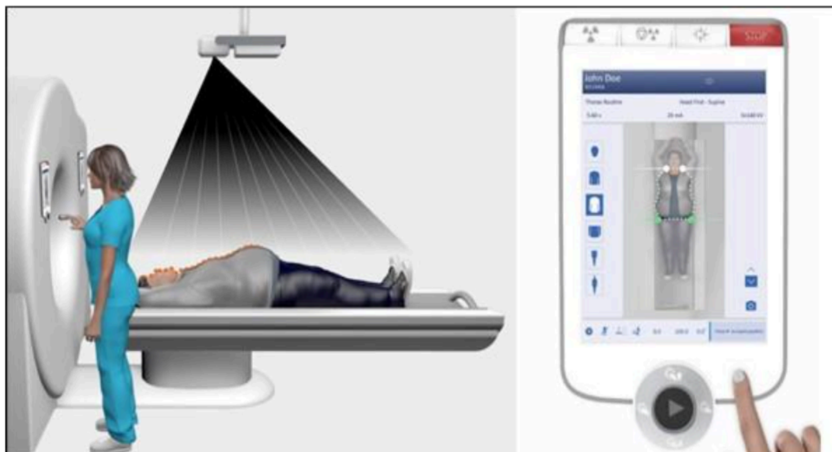
Figura 2. Ilustração do funcionamento da câmera 3D para o posicionamento automatizado em exame de TC através de algoritmos de IA (23) .
